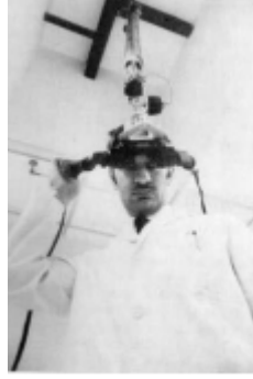
Şekil 3.4. Stereoskopik HMD (Çoruh, 2011)
