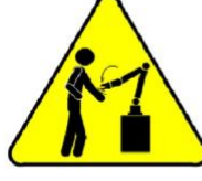
Robot Kıskaçının Çarpması
