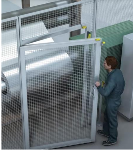
ŞEKİL 87: EN ISO 14120'de Bahsedilen Arakilitemeli Hareketli Muhafaza (SICK, 2018)
