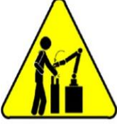
Kıskaç ve Fikstür Arasında Sıkışma
