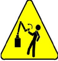
Parmakları Kıskaçta veya Parça Boşluğuna Kaptırma
