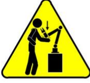
Robotun hareketli mafsalla çarpması
