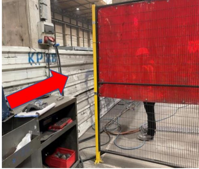
ŞEKİL 61: Uygunsuz Emniyet Çiti Tasarımı (Tehlikeli Robot Hareketine Erişimin Tamamen Kapatılması Gerekir) (Laurent Giraud, Ph. D., 2009)
